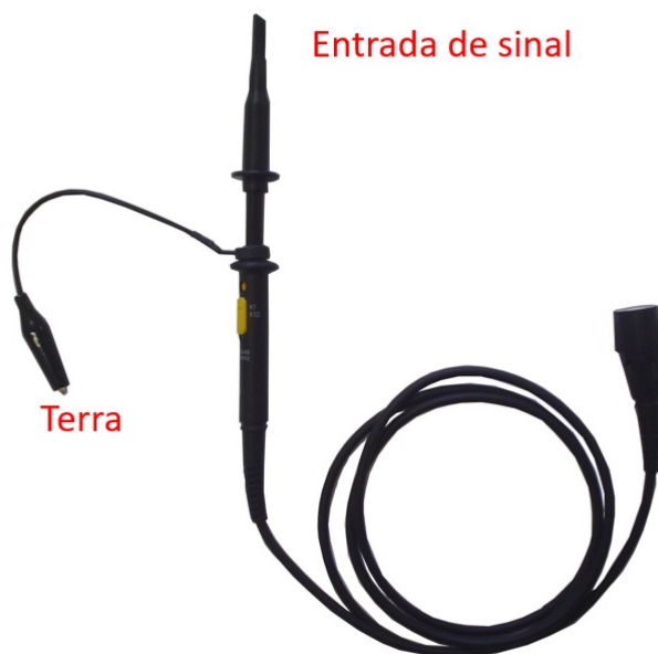
Figura 32: Ponta de prova passiva para medição de tensão.
