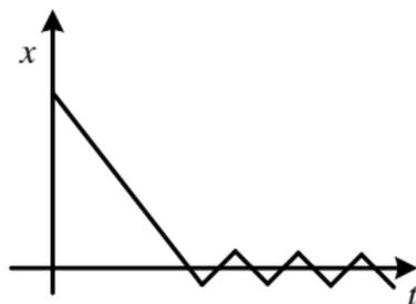
Ou seja, o sistema **desliza** ao longo do tempo em torno de  $x = 0$ . Dizemos que  $x = 0$  é a **superfície de deslizamento**. Nessa condição, não existe o modo do sistema com derivada positiva, e nem o modo do sistema com derivada negativa. O sistema ganha um novo modo, o chamado modo deslizante (do inglês, *sliding mode*).
