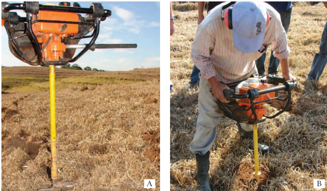
Figura 57: Aspecto de uma motocoveadora (A) e abertura de cova com motocoveadora (B).
