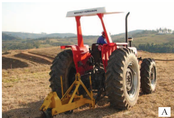
Figura 54: Área com o mato já seco, após aplicação de herbicida, sendo preparada para o plantio com um subsolador florestal (A) e técnico medindo a profundidade de subsolagem com uma haste de ferro (B).
