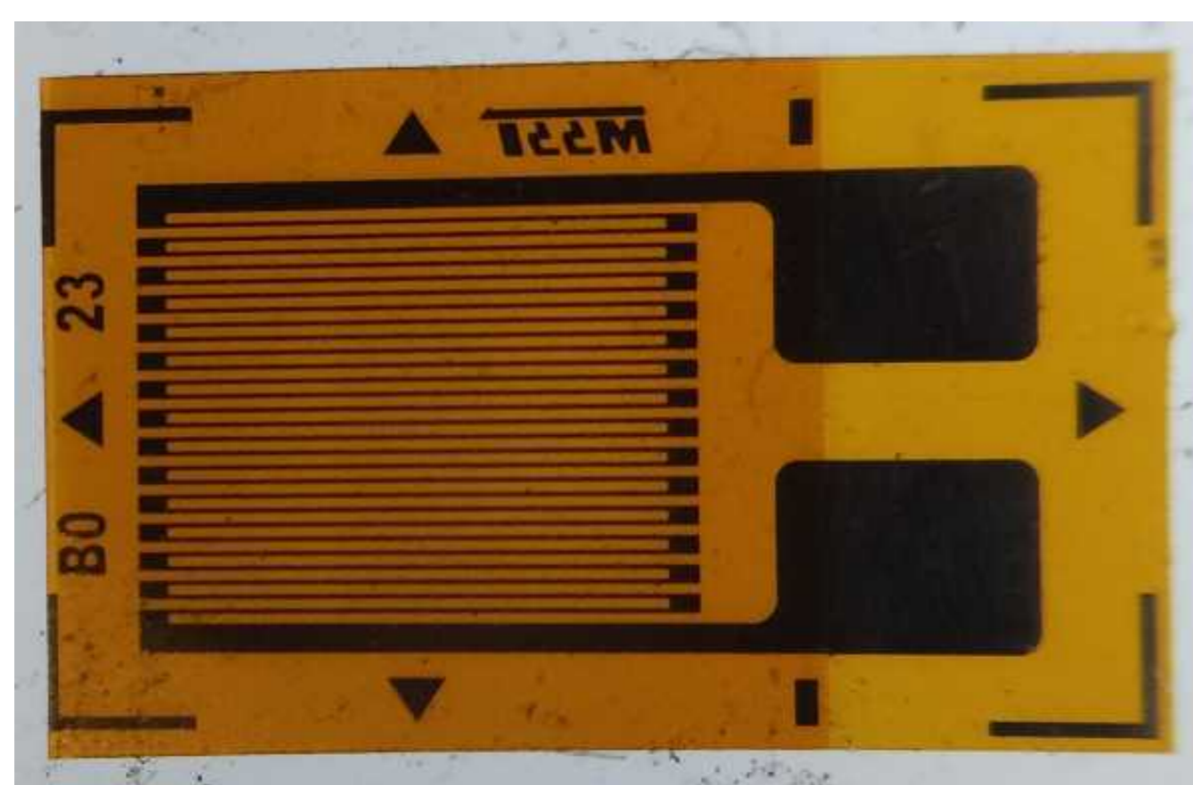
Figura 1: Strain Gauge, obtido em [Wik]
