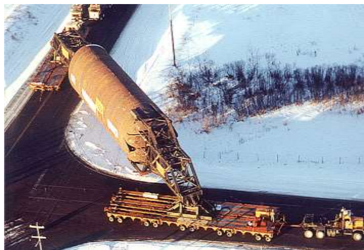
Figura ... – curva no transporte de um grande equipamento
