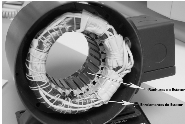
Figura 1 – Estator de um motor BLDC. Adaptado de [1]
