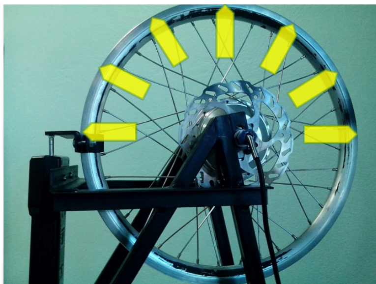
Figura 4.2: Mecanismo de medida, visto lateralmente. Detalhe das diferentes posições em que foram feitas as medições. Fonte: (BLOS et al., 2017), com contribuição do técnico Rui Berto e Prof. Manoel.
