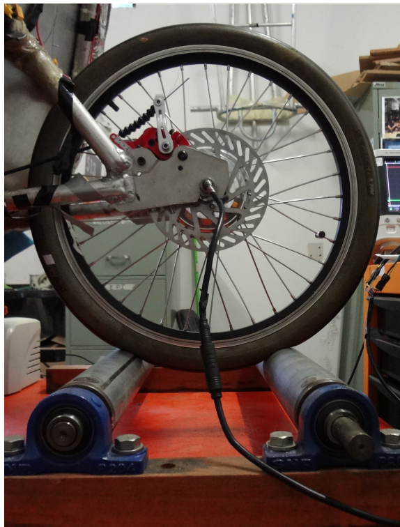
Figura 4.5: Detalhe da montagem com os rolamentos onde foi apoiada a roda do motor. Fonte: Autoria própria com contribuição de Rui Berto.
