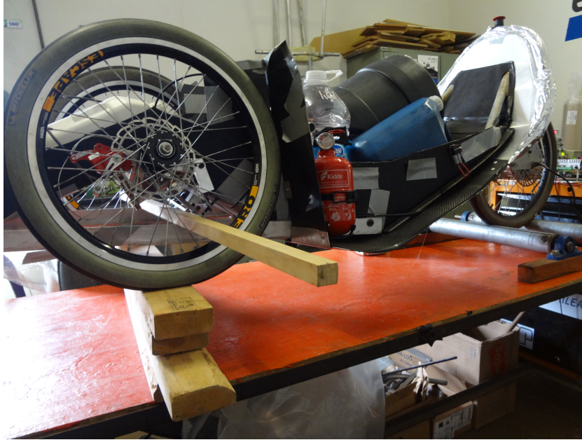
Figura 4.6: Protótipo Venturo com carga. Detalhe dos calços nas rodas dianteiras. Fonte: Autoria própria.
