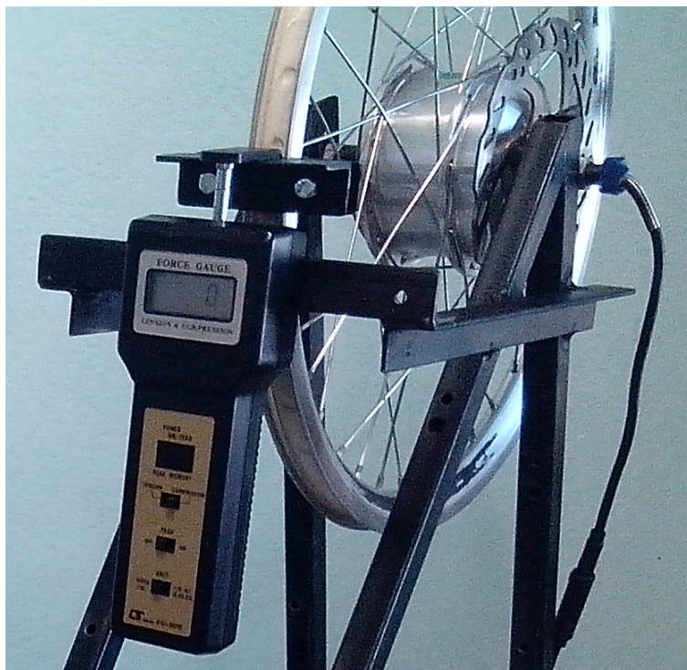
Figura 4.1: Mecanismo de medida, visto de frente. Fonte: (BLOS et al., 2017), com contribuição do técnico Rui Berto e Prof. Manoel.
