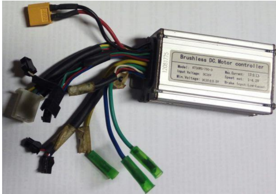
Figura 4.8: Controlador comercial utilizado no Ensaio de Partida em Rampa com Carga. Fonte: Autoria própria.
