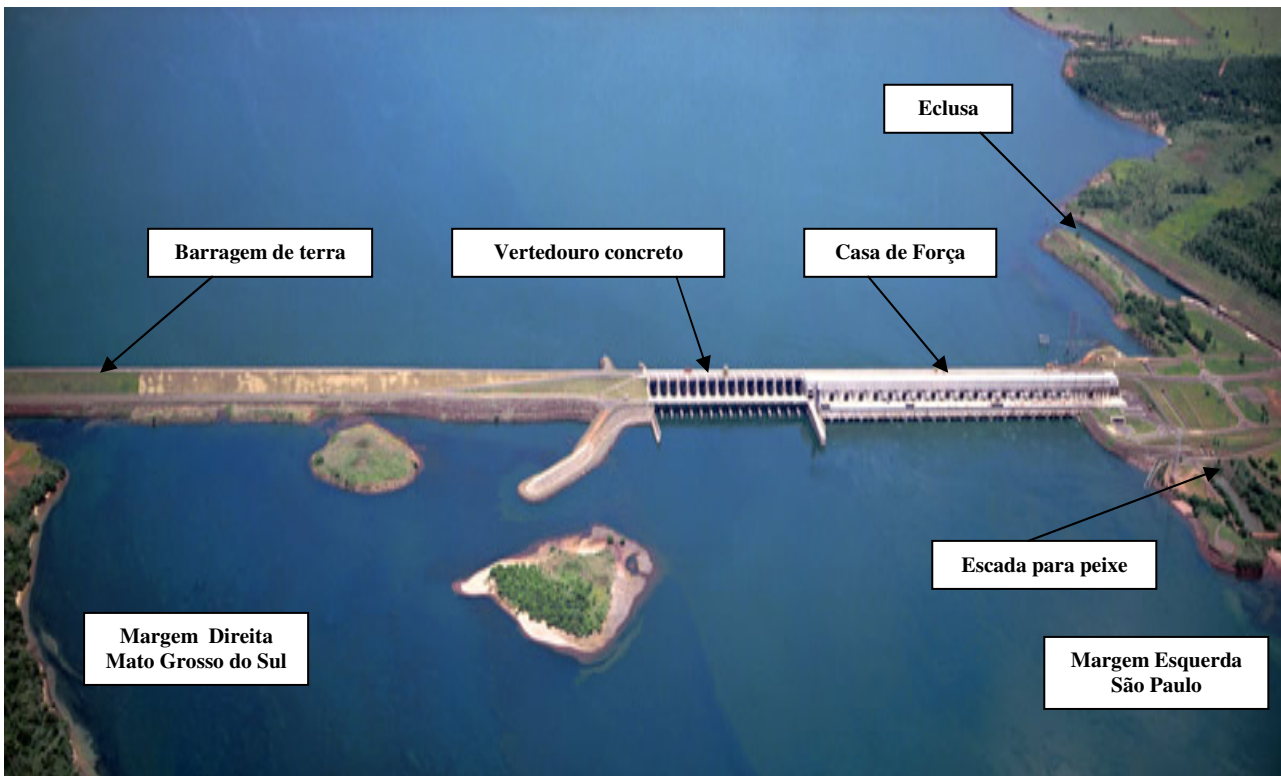
Vista aérea - Usina e Eclusa Porto Primavera – Engenheiro Sérgio Motta Engº Civil - Luiz Antonio Batista da Rocha – Responsável pelo Setor Técnico da CESP Construção das Barragens: Porto Primavera no rio Paraná - Rosana, Canoas I e II, no rio Paranapanema.
