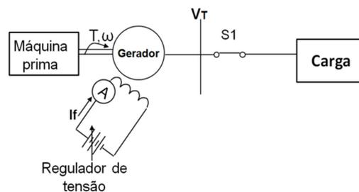
Exemplo 1) Um gerador síncrono, 480V, 60Hz, ligação  $\Delta$ , 4 pólos, possui uma curva de saturação. Este gerador possui uma reatância síncrona de  $0,1\Omega$  e  $R_a = 0,015\Omega$ . A máquina tem uma curva de saturação em vazio como mostra a figura abaixo.
