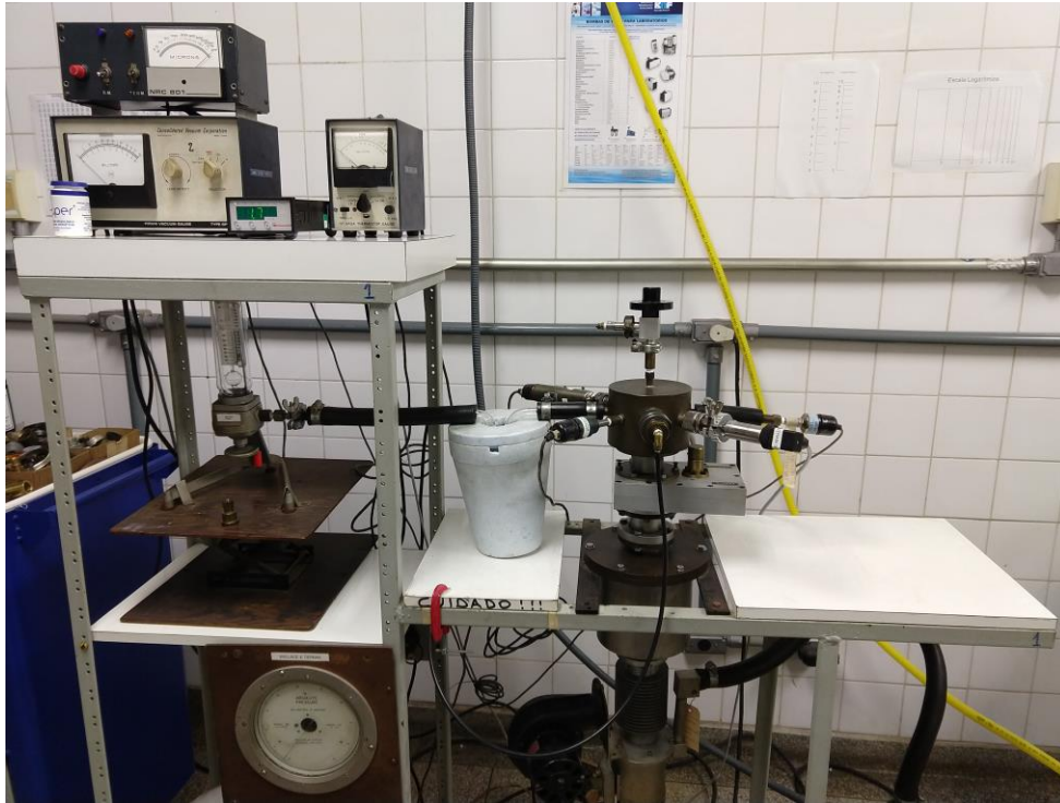
Figura 2. Vista frontal do sistema de vácuo da Bancada 1.
