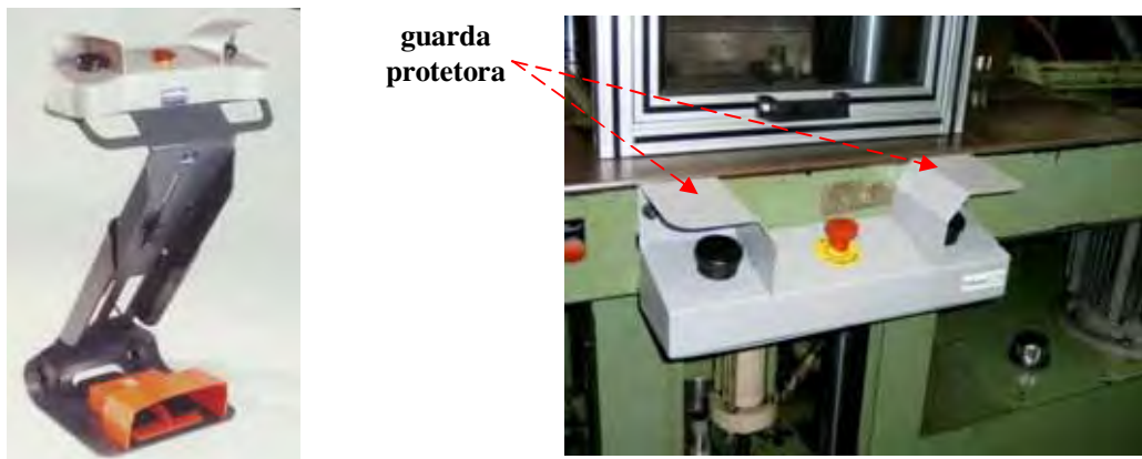
Figura 18 – Exemplos de dispositivos de comandos bimanuais
