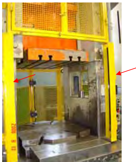
Figura 22 – Exemplo de cortina de luz instalada em prensa
