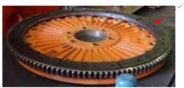
Figura 12 - Lonas de freio do conjunto de freio/embreagem
