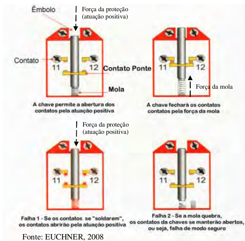
Figura 17 – Esquema simplificado de atuação positiva do embolo da chave de segurança sobre os contatos
