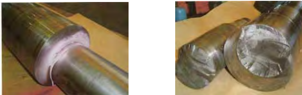
Figura 6 – Exemplos de eixos rompidos por efeito de sobrecarga.
