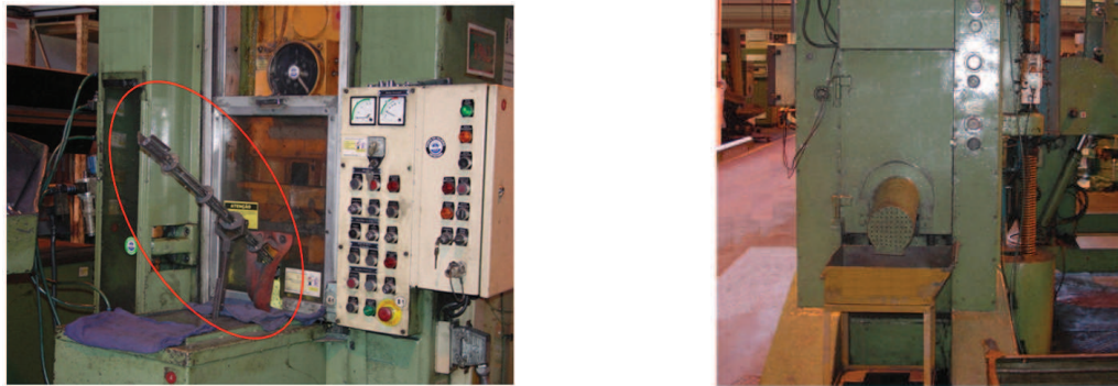
Figura 153 – Alimentação através de dispositivo por gravidade.
