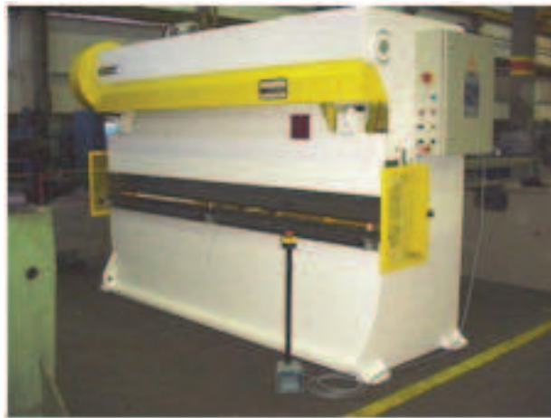
Figura 97 - Dobradeira Descendente Mecânica c/ freio-fricção pneumática
