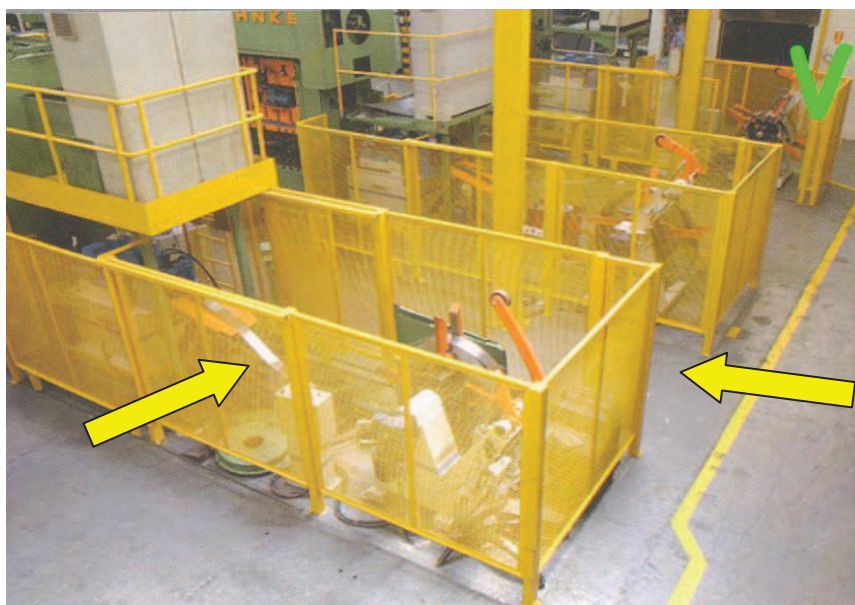
Figura 157 – Área de desbobinadeira protegida.
