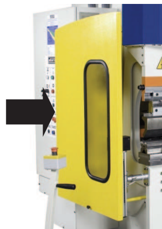
Figura 102 - Proteção contra acesso lateral
