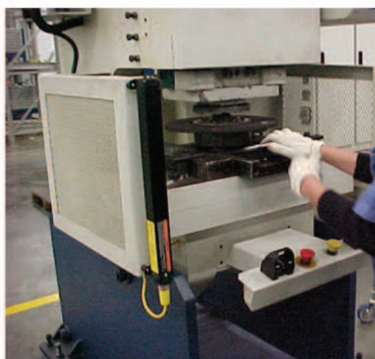
Figura 151 – Sistema de alimentação por gaveta manual conjugada com cortina de luz e comando bimanual.
