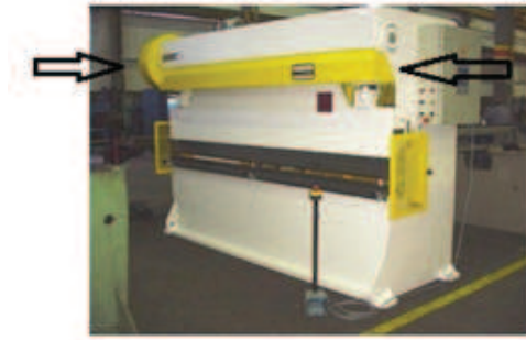
Figura 124 - Prensa Dobradeira com acionamento mecânico com sua transmissão de força protegida.
