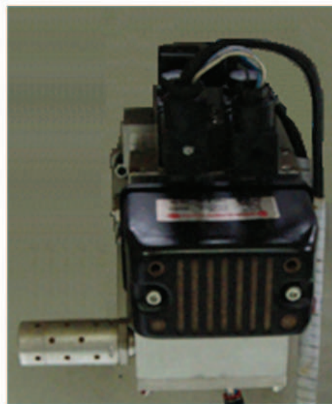
Figura 93 – Válvula pneumática de segurança de fluxo cruzado com silenciador incorporado.
