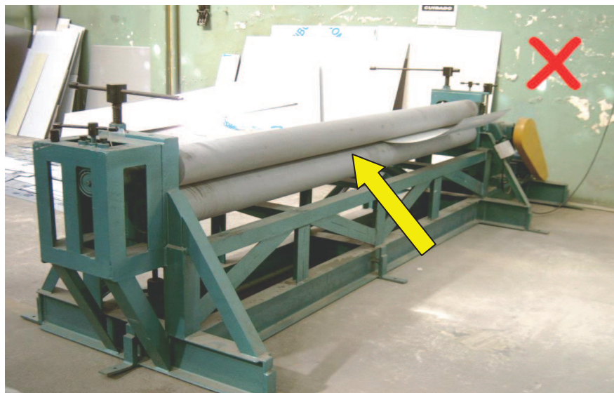
Figura 135 – Calandra sem proteção.
