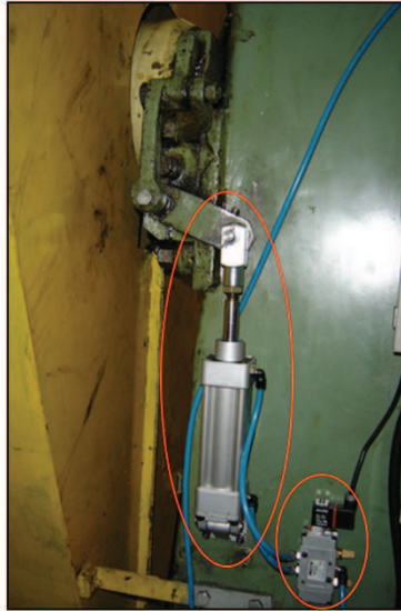
Figura 50 - Válvula eletropneumática e pistão em substituição ao pedal mecânico
