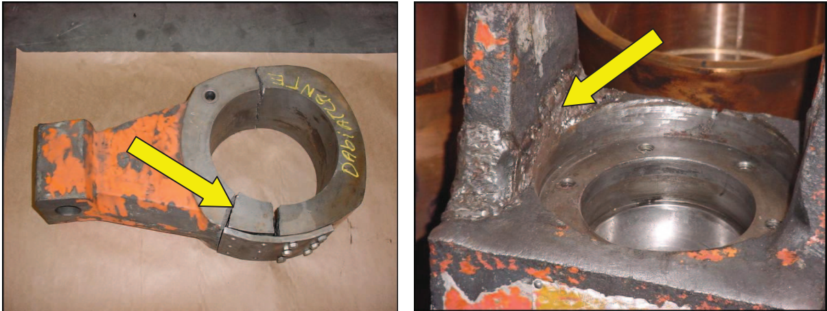
Figura 173 – Resultados de manutenções inadequadas
