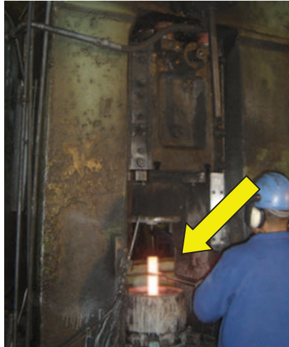
Figura 147 – Alimentação manual com tenaz no forjamento a quente.
