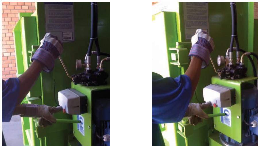
Figura 146 – Exemplo de sistema de acionamento de exige o uso das duas mãos dos operadores para o acionamento da máquina.
