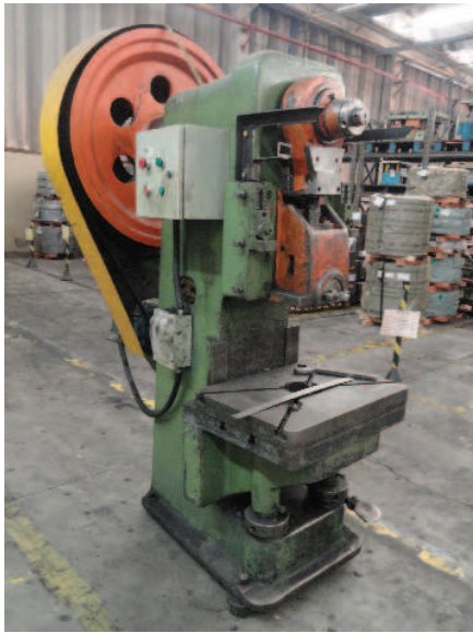
Estrutura em "C"
