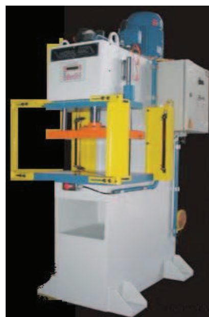
Figura 25 – Cortina de luz com espelhos para proteção frontal e lateral.
