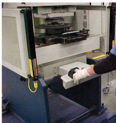
Figura 151 – Sistema de alimentação por gaveta manual conjugada com cortina de luz e comando bimanual.
