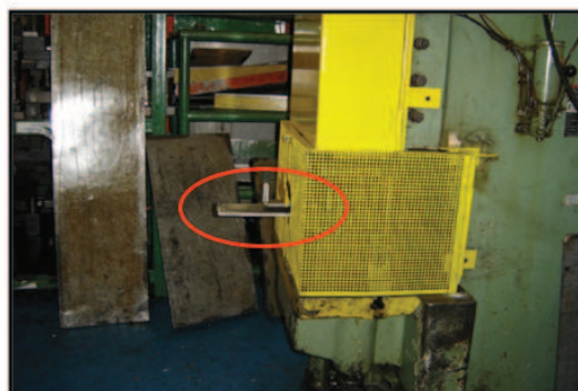
Figuras 150 - Dispositivo tipo gaveta com movimentação manual, com a área de risco totalmente protegida.
