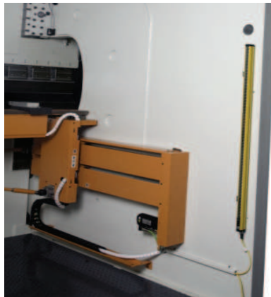
Figura 116 - Proteção traseira com cortina de luz
