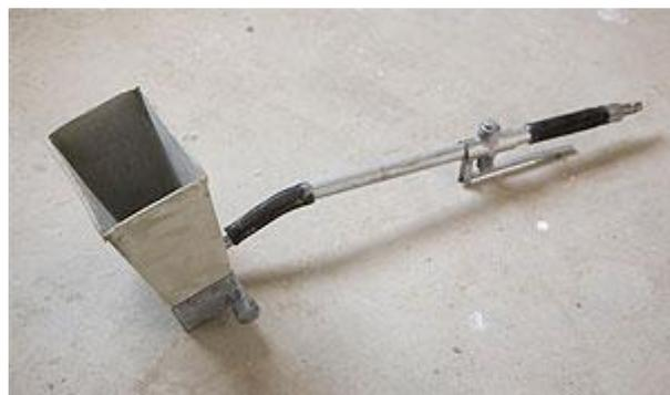
Projetores por spray com recipiente acoplado garantem facilidade de manuseio e qualidade à aplicação da argamassa
