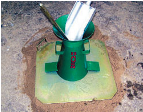
Figura 5 - Conjunto completo para ensaio de abatimento (haste, funil, placa e concha)
