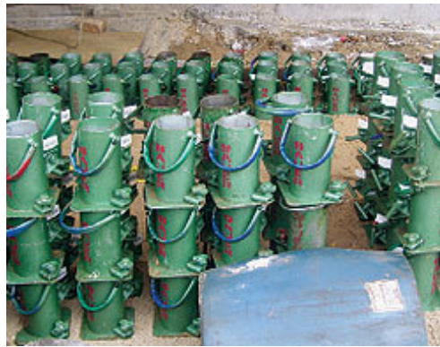
Figura 6 - Moldes para corpos de prova de concreto
