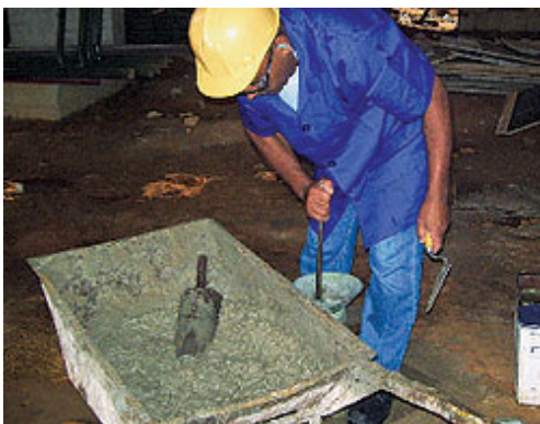
Figura 3 - Ensaio de abatimento (slump)
