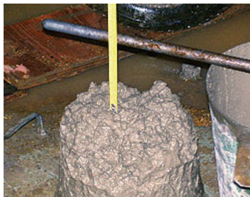
Figura 4 - Medida do abatimento (resultado em mm)
