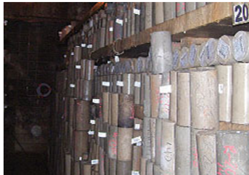
Figura 8 - Corpos de prova armazenados em câmara úmida, com temperatura e umidade relativas do ar controladas
