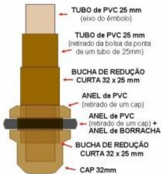
Figura 5.18 - Ilustração da união por ponta e bolsa.
