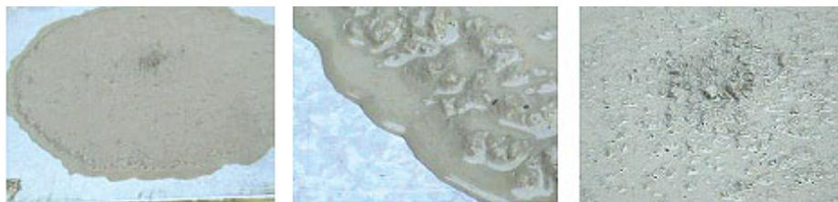
**Figura 1** – Observação de instabilidade da mistura (segregação) pelo ensaio de espalhamento no tronco de cone
