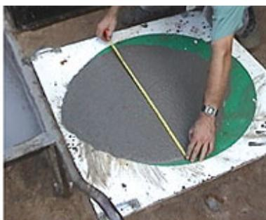
**Figura 6** – Ensaio de espalhamento do tronco de cone. (a) Retirada do cone; (b) Medição do espalhamento
