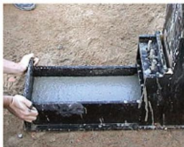
**Figura 7** – Ensaio na caixa-L. (a) Escoamento e passagem pelas barras de restrição; (b) Estado final ao término do escoamento
