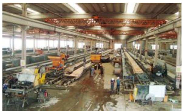
Figura 5 - Planta de produção de lajes alveolares protendidas
