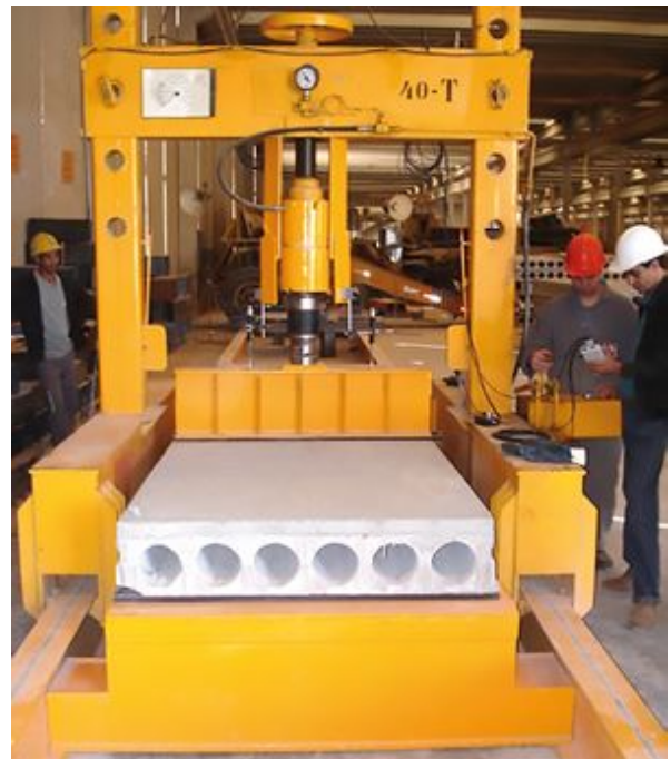
Figura 1 - Seção típica da laje alveolar, com capa estrutural. Peça sendo submetida a ensaios de flexão e cisalhamento dentro da indústria para trabalhos de pesquisa e desenvolvimento
