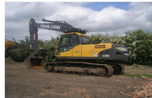
Escavadeira de 21t. (150,00 m 3 h)
