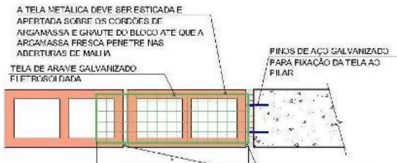
Planta fixação pilar/alvenaria
