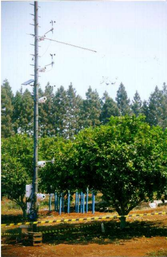
Medida da ETc com o Sistema de Razão de Bowen em Citros
