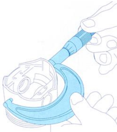
Figura 3.4 – Realizando uma medida com um micrômetro simples.
