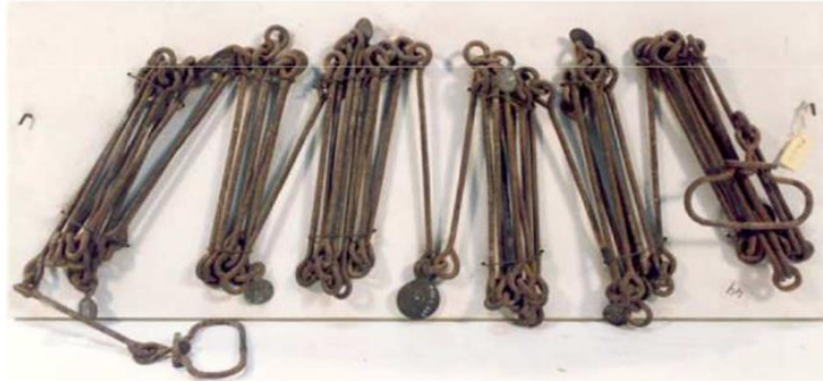
Figura 4 - Corrente ou cadeia de agrimensor. Fonte: Autoria própria.
