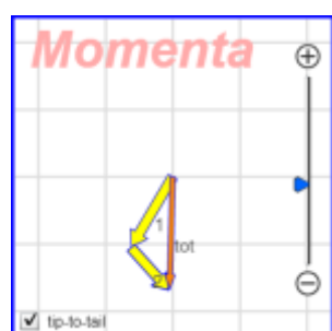
Figura 11: Diagrama retirado do site de auxílio sobre a soma vetorial dos momentos lineares dos corpos 1 e 2 depois de uma colisão totalmente elástica.
