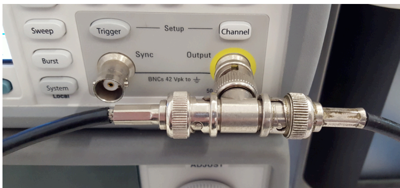
Exemplo de derivação do sinal da saída de um gerador de funções utilizando-se o adaptador tipo T
