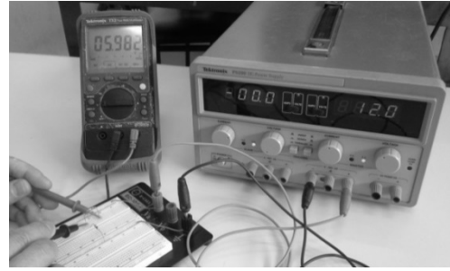
Figura 2: Montagem do circuito em protoboard e procedimento de medição.
