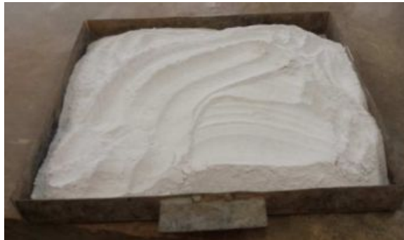
Figura 10: Grande camada de gesso calcinado em bandeja Fonte: ERBS (2015)
