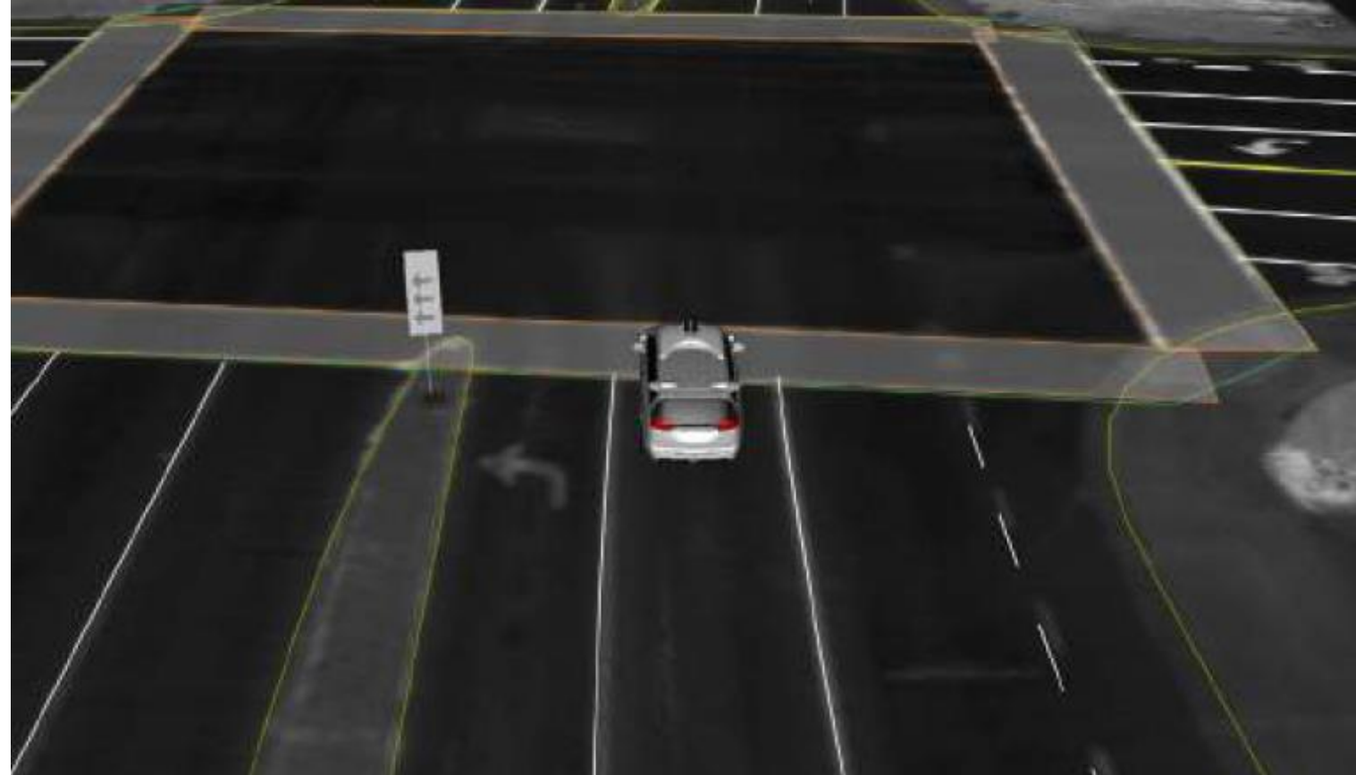
Visão do mapa embarcado de um carro autônomo da Waymo numa intersecção em Mountain View, CA.
