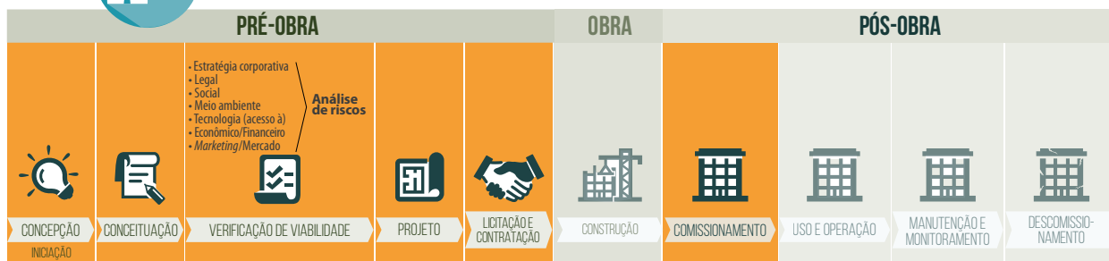
Figura 11: Ciclo de vida típico de um empreendimento, com destaque para as fases que estariam no foco de interesse de uma incorporadora
