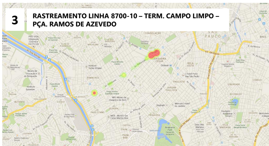
Trecho com retenção isolada (semáforo)
