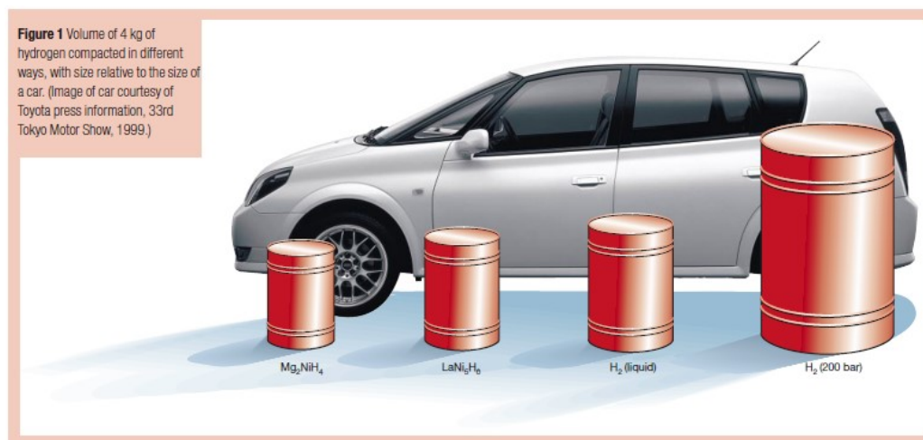
Figura 2: Comparação do volume necessário para diferentes métodos de armazenamento de Hidrogênio relativos ao tamanho de um carro
