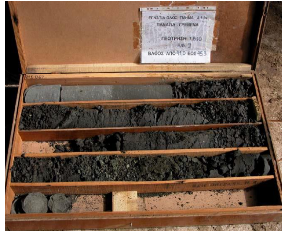
Testemunhas após 6 meses (alteração dos siltitos)
