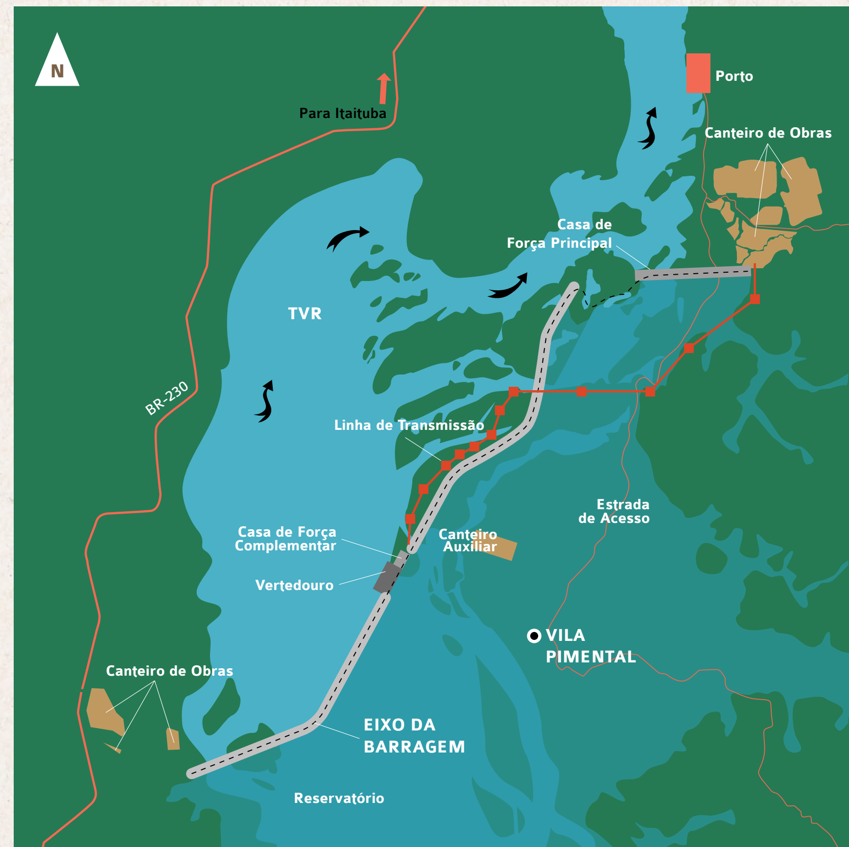
Arranjo geral da barragem e das obras
