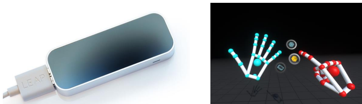
Figura 4 – Dispositivo Leap Motion e exemplo de aplicação.
