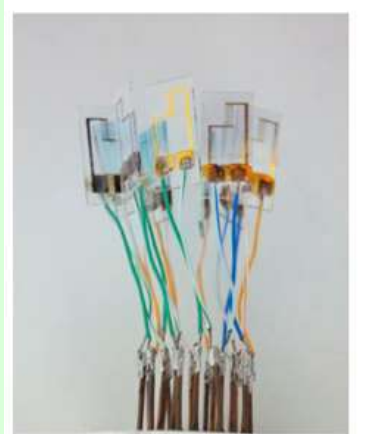
Foto de um conjunto de eletrodos de ouro, que compõe uma língua eletrônica, recoberto com filmes ultrafinos (Imagem: Osvaldo Novais)
