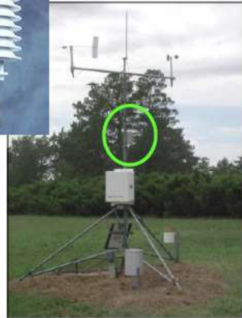
Abrigo meteorológico utilizado em estações meteorológicas automáticas
