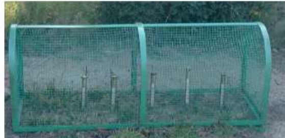
Geotermômetros instalados em solo desnudo
