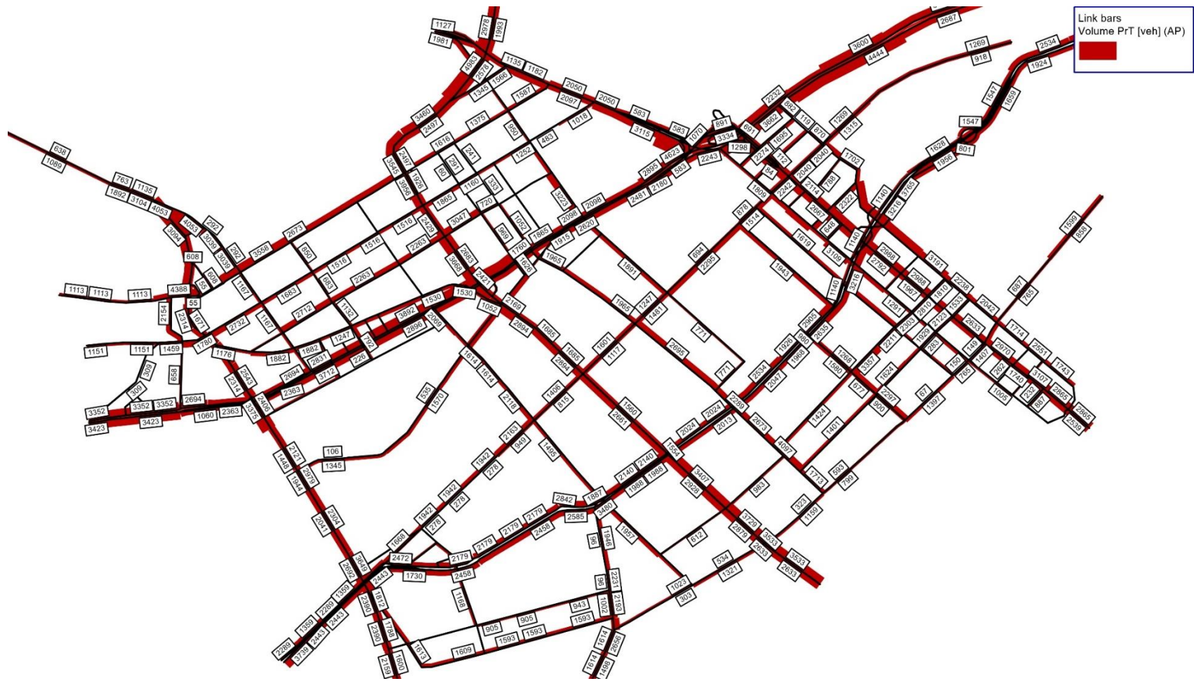
Figura 41 - Alocação final de tráfego na rede, para a hora pico da manhã.
