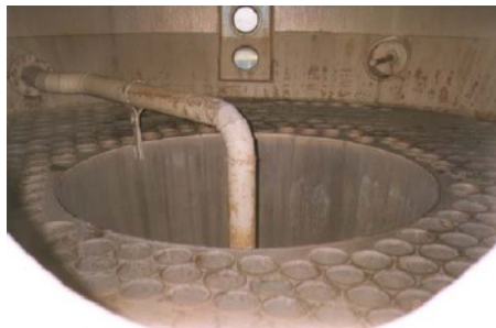
Vista interna do Cozedor (calandra fixa e plana, com tubos maiores para melhor circulação da massa).
