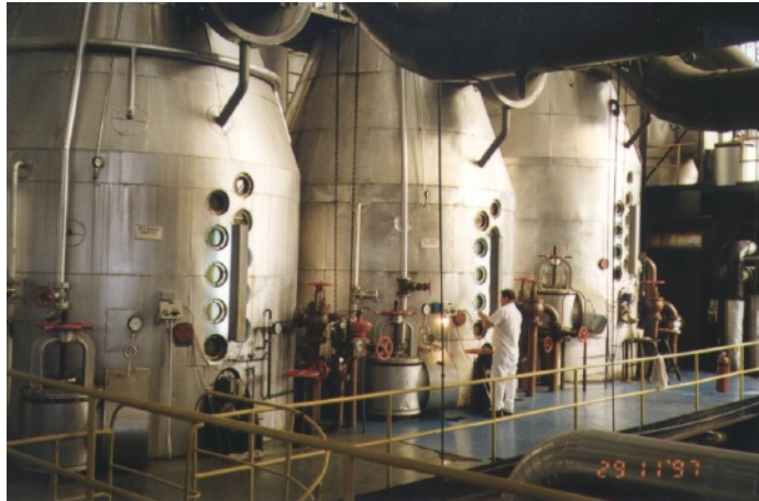
Cozedores à Vácuo para Açúcar Refinado Granulado - Refinadora Catarinense
