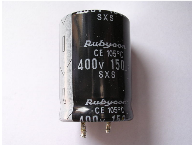
Figura 2.5: Capacitor eletrolítico bastante comum no mercado
