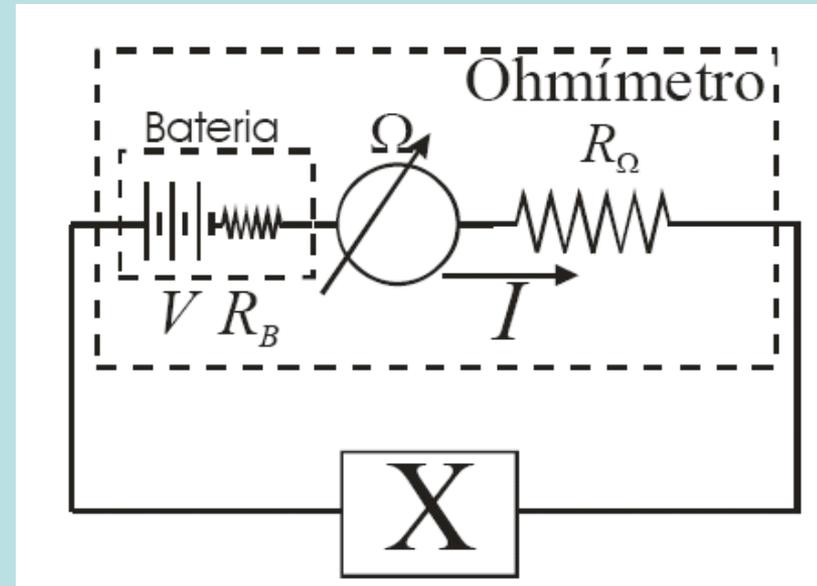
Se  $R_R \gg R_B + R_\Omega$  essa resistência pode ser desprezada e a resistência medida é aproximadamente igual a  $R_R$
