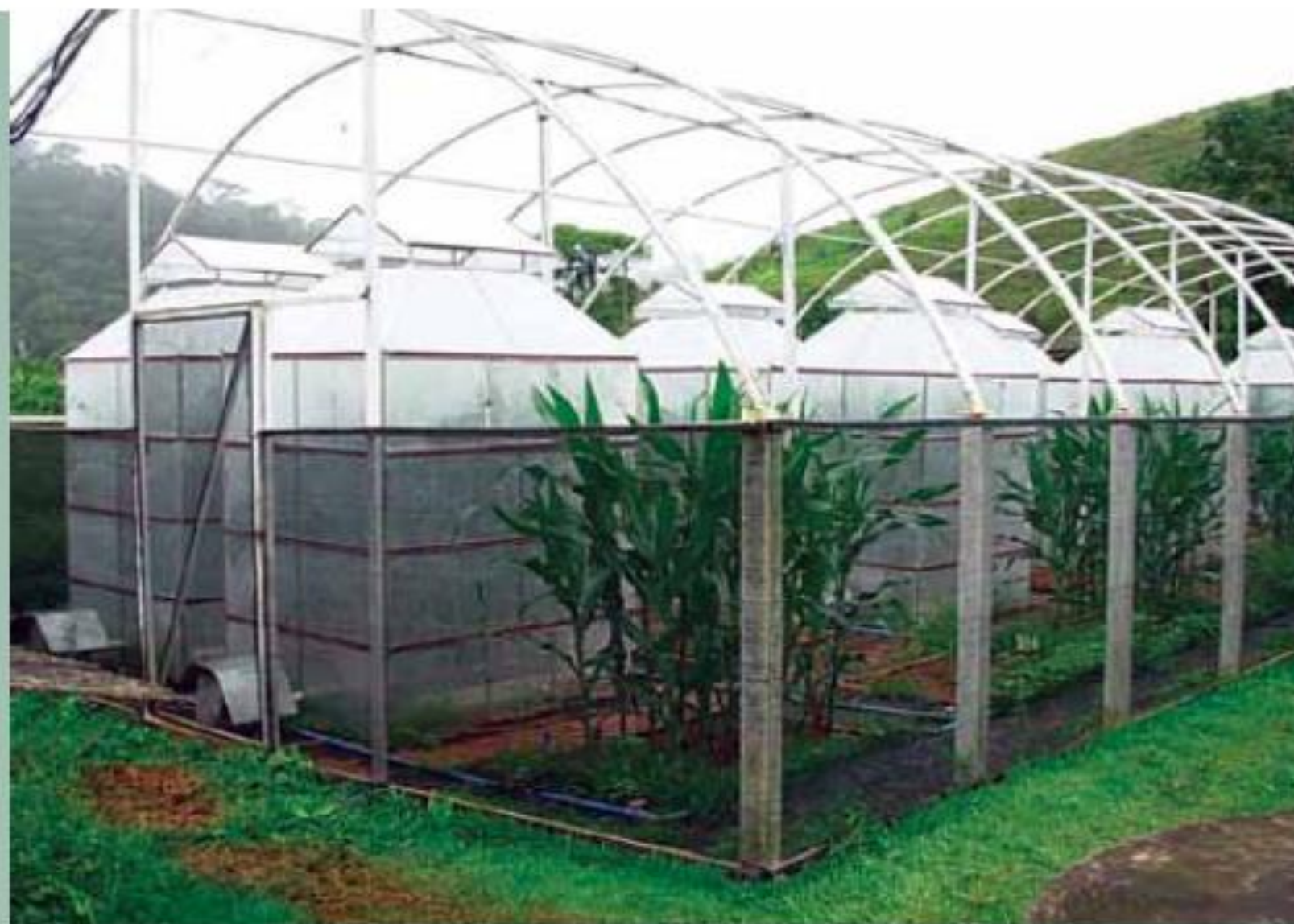
Câmaras de topo aberto usadas para simular uma atmosfera enriquecida com diferentes níveis de \text{CO}_2 semelhante à dos cenários de emissões B2 and A2 do IPCC.
