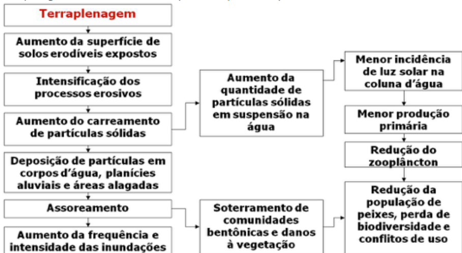
Figura 3 – Diagrama de interação dos impactos ambientais deflagrados pelas atividades de terraplenagem sobre os ecossistemas aquáticos: aspectos e impactos ambientais
