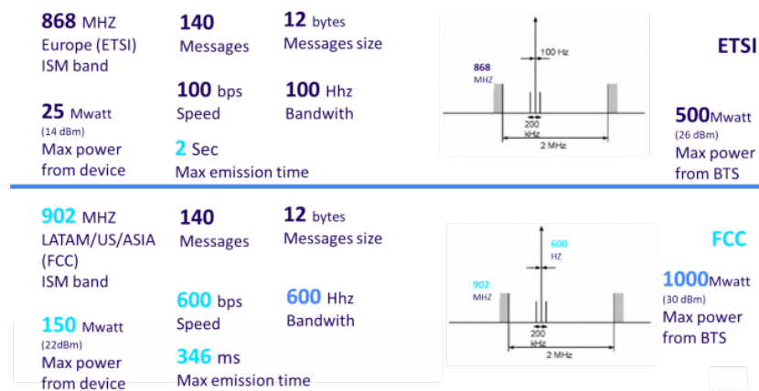
Figura 6: Comparação do uso na tecnologia Ultra Narrow Band nas regiões ETSI e FCC.
