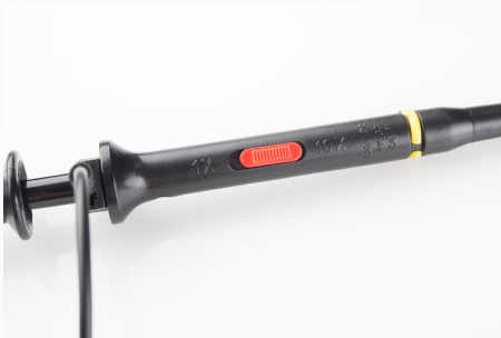
Figure 7: Ponta de prova e sua opção de atenuação de 10 vezes (10X).
