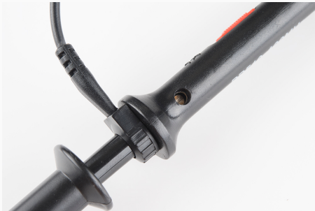
Figure 8: Calibração da ponta de prova pela sua capacitância variável.
