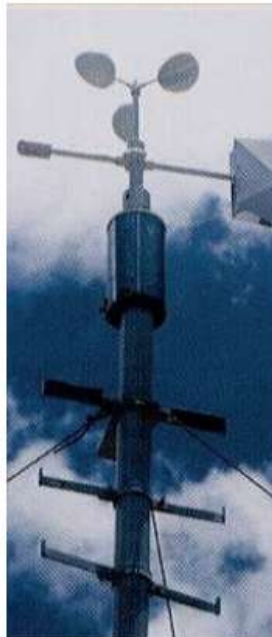
Anemômetro Universal – Equipamento mecânico que fornece dados de direção, velocidade e rajadas
