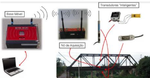
Figura 15 - Sistema sem fio e sem necessidade de programação, com sensores inteligentes ("Plug and Play").
