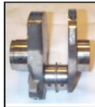
Figura 2.12 – Secção do virabrequim a ser ensaiada.
