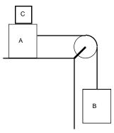
A figura ao lado representa dois blocos ligados por uma corda leve e inextensível. As massas de A e B são, respectivamente, 10 e 5 kg. O coeficiente de atrito de A com a mesa é 0,2, e não há atrito entre os blocos A e C nem entre o fio que liga os blocos e o guia do fio, que está fixo. Inicialmente, o sistema está parado, com o bloco B a 0,5 m do chão.
