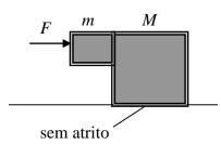
mover. A superfície de contato entre eles é vertical, e o coeficiente de atrito estático entre os blocos é  $\mu_e = 0,4$ . A superfície abaixo de M é lisa, sem atrito, e o conjunto é acelerado pela força F de modo que o bloco pequeno não se move em relação ao grande.
