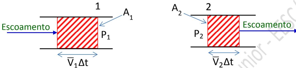
Durante um intervalo de tempo  $\Delta t$ , a massa de fluido que entra no volume de controle é  $\rho_1 A_1 \bar{V}_1 \Delta t$ , e a massa que sai é  $\rho_2 A_2 \bar{V}_2 \Delta t$ . Considerando a direção  $x$ , a quantidade de movimento adicionada é  $\rho_1 A_1 \bar{V}_1 \Delta t v_{x1}$  e a quantidade de movimento retirada é  $\rho_2 A_2 \bar{V}_2 \Delta t v_{x2}$ . Assim, teremos:
