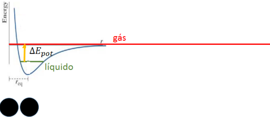
Figura 3. Energia potencial de um par de moléculas. A distância média entre duas moléculas na fase líquida corresponde a uma energia potencial muito menor deste par, em comparação com o mesmo par na fase gasosa.
