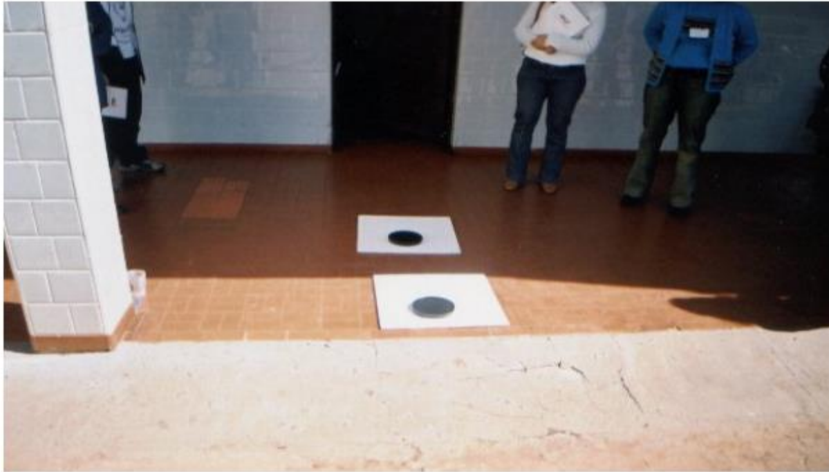
Experimento de determinação da constante solar pelo derretimento de gelo escurecido (Santa Rosa, RS, 05/2003).
