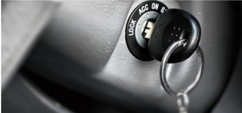
Controle de automóveis tem um dispositivo à prova de erros que assegura que a chave esteja na posição “*on*” antes de permitir que o câmbio possa ser movido para a posição “*drive*”. As chaves não podem ser removidas da ignição até que o câmbio esteja na posição “*park*” ou “*neutral*”.
